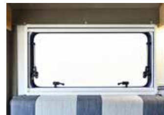
アクリル二重窓 高い断熱性を発揮。キャビン内の冷暖房効果も高めてくれます。
