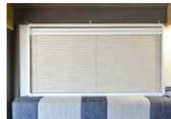
遮光ブラインド アクリル窓に遮光ブラインド内蔵。逆側には換気用メッシュも装備。
